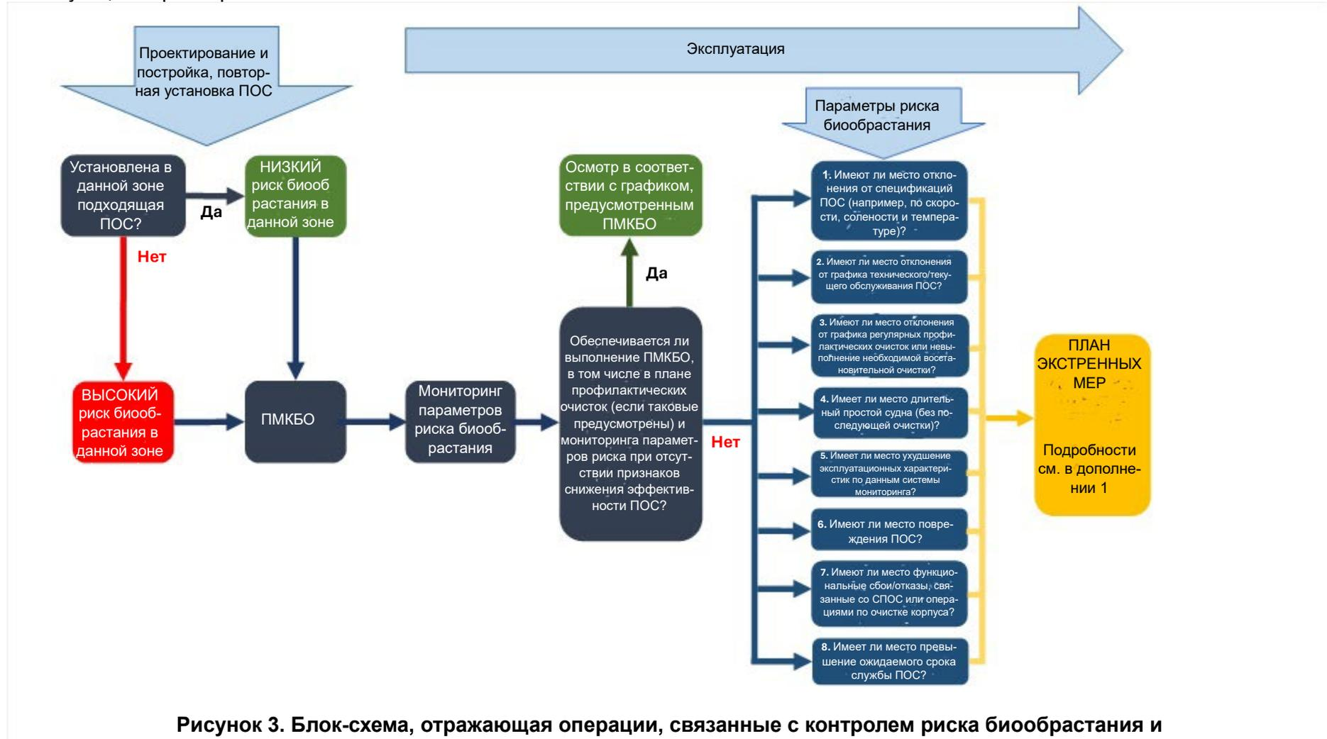
Рисунок 3. Блок-схема, отражающая операции, связанные с контролем риска биообрастания и мониторингом соответствующих параметров
